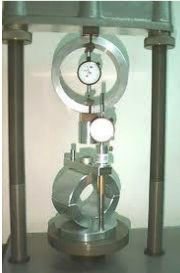
Imagen 2. Prueba de estabilidad y flujo para encontrar el contenido óptimo de asfalto con la prueba de Marshall para concreto asfáltico.
