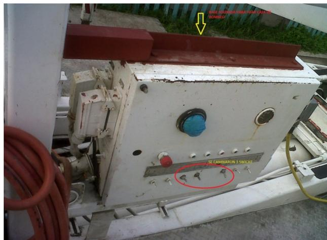
Señalamiento en la caja de control de bombeo externo, de la bomba pluma.
