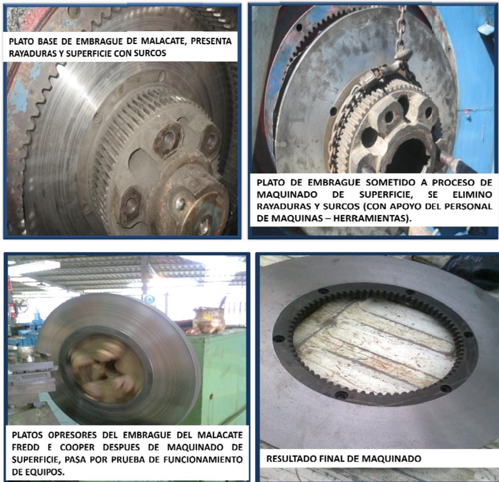
Pruebas de funcionamiento de plato base del campo rodador.
