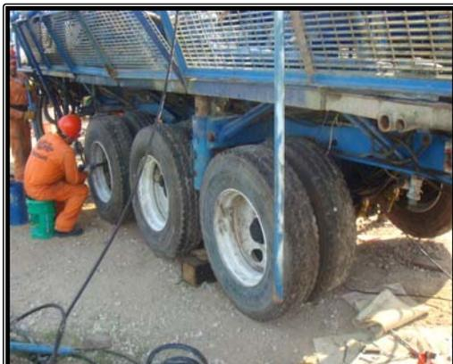
Instalación de neumáticos, alineación del tren del remolque e instalación del sistema eléctrico del remolque.
