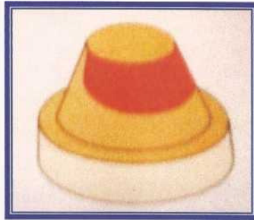
Figura 9: Conicidad exagerada de la preparación
