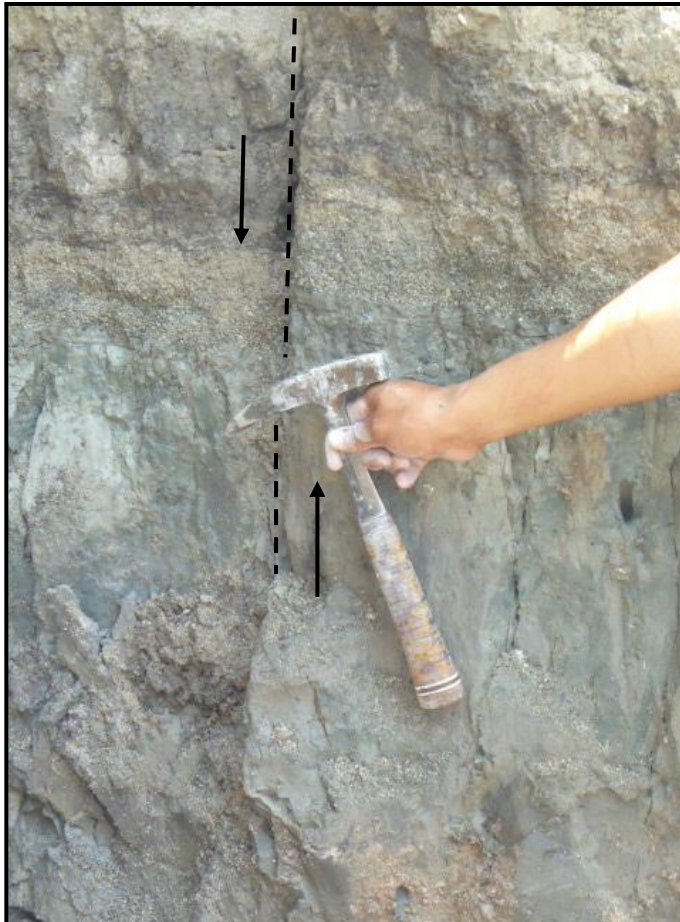
Imagen 3 y 4. Falla que muestra un desplazamiento de 10 cm, ubicada a 32m al sur, de la unidad habitacional La Concordia, en el subsuelo de una construcción de edificios habitacionales. (Tomada de Zamudio-Ángeles et al. , 2010)
