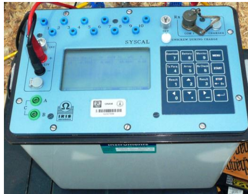
Figura 29.- Equipo de medición para la tomografía eléctrica. (Syscal-pro switch 48, de Iris instruments)
