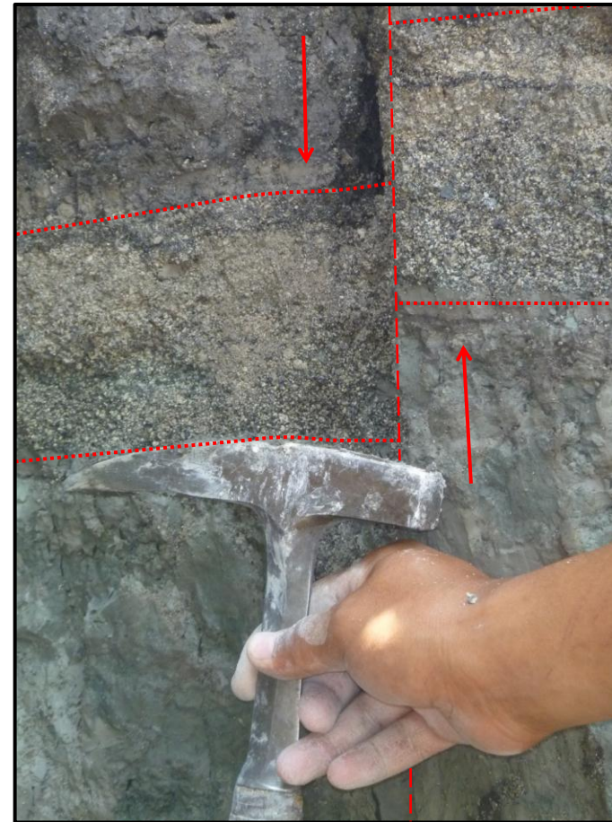
Imagen 3 y 4. Falla que muestra un desplazamiento de 10 cm, ubicada a 32m al sur, de la unidad habitacional La Concordia, en el subsuelo de una construcción de edificios habitacionales. (Tomada de Zamudio-Ángeles et al. , 2010)
