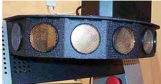
Figura 3.6: Arreglo de sonares del robot Peoplebot (© Adept Mobile Robots).
