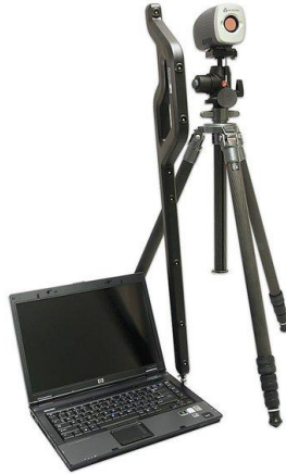
Fig. 4.4. Elementos de la máquina de medición por coordenadas portátil Metronor System SOLO (cámara, bastón con puntero y computadora).
