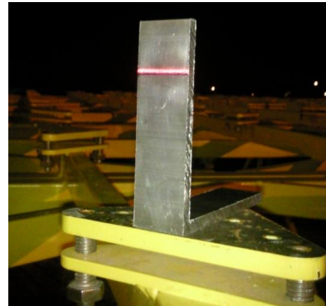
Fig. 4.9. Proyección del laser sobre la marca de la escuadra.
