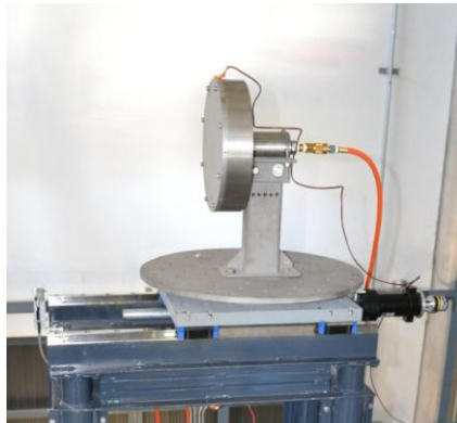
Fig. 5.5. Blanco receptor de placa plana para la captura y procesamiento de imágenes.
