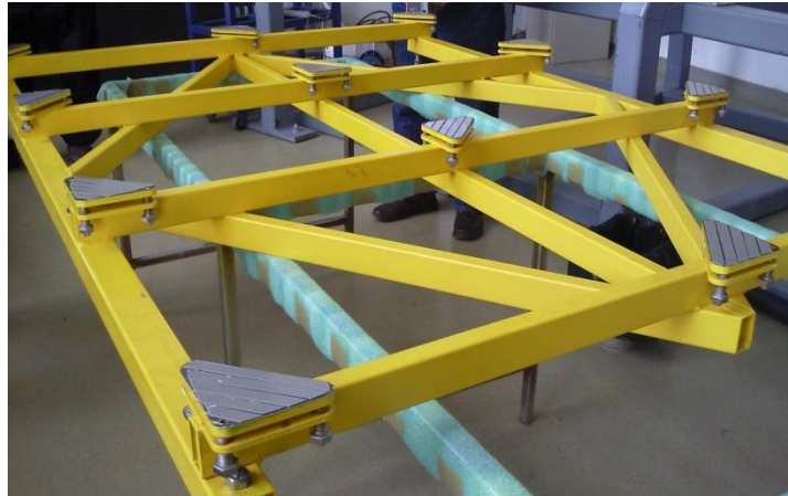
Fig. 4.13. Platinas cubiertas con cinta adhesiva tipo "doble cara" para el pegado del espejo.
