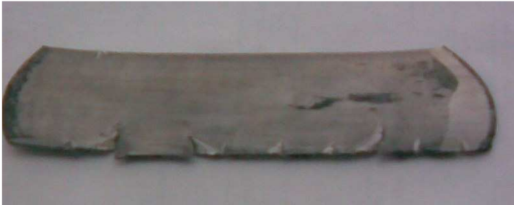
Figura 2. 4 Muestra procesada por laminación en frío.
