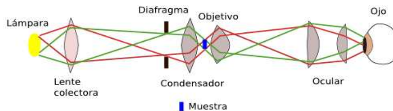
Figura A. 2 Diagrama esquemático de funcionamiento de los lentes ocular y objetivo.
