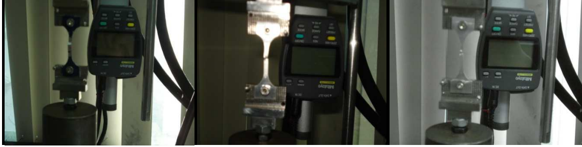
Figura 2. 14 Estado de las probetas al finalizar la prueba de tensión.
