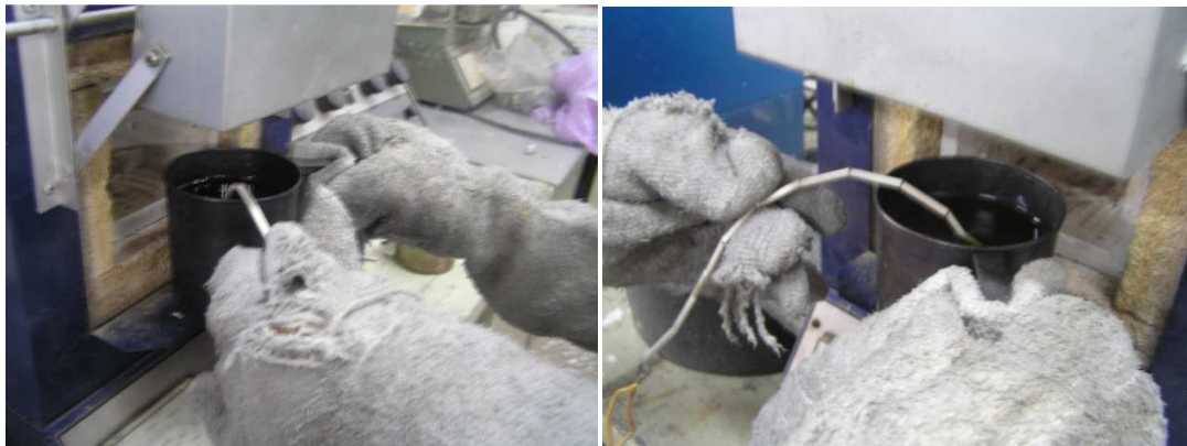
Figura 2. 12 Colocación de probetas en horno para tratamiento térmico.
