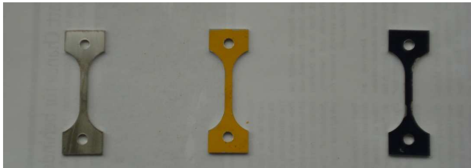
Figura 2. 11 Probetas fabricadas de las respectivas aleaciones.
