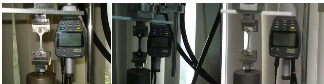
Figura 2. 13 Probetas colocadas en el equipo MTS Minibionix.
