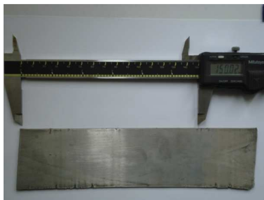
Figura 2. 6 Muestra de AZ31 procesada por laminación y preparada para fabricación de probetas.
