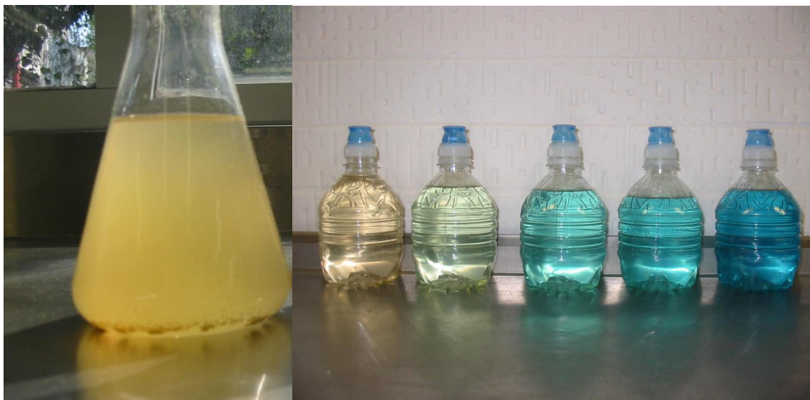
Figura 3.17 Muestra del Influyente, Filtrado y diferentes tonalidades del agua tratada con colorante.
