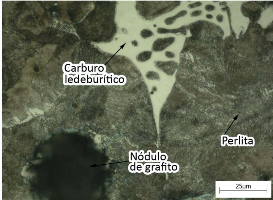
Figura 4.3.- Detalle de la microestructura observada en la Figura 4.2. Atacada con Nital al 2%.
