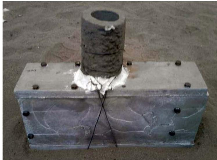
Figura 3.3.- Molde con enfriador de aluminio antes de la colada.
