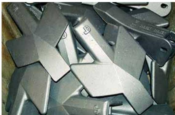
Figura 2.11.- Puntas de rasgado utilizadas por la empresa John Deere en algunos de sus equipos, fabricadas en CADI para una buena resistencia al desgaste y tenacidad en suelos rocosos abrasivos. [22]
