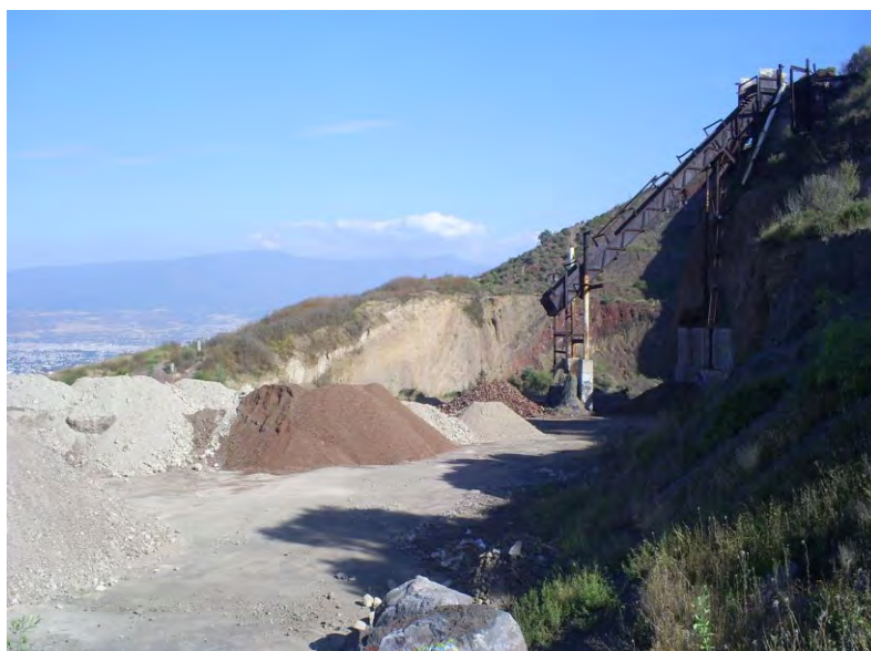
Foto V-1. Aquí se aprecian los materiales que se seleccionan de la mina como arena, grava y tezontle.
