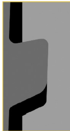
Figura 3.20 Perfil general de la rosca semilisa integral (V&M, 2009)
