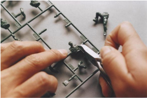
Paso 26. Desmonte de las piezas de la grapa contenedora.
