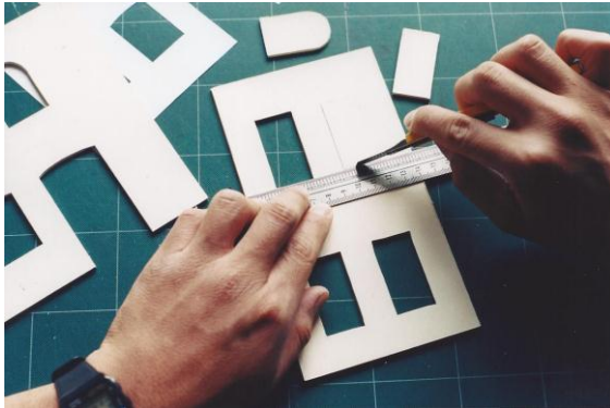
Paso 3. Una vez pegada la cartulina se cortan las ventanas de los muros.
