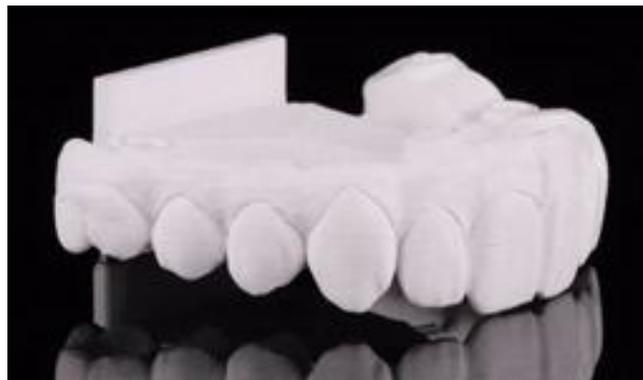
**Fig. 3** Estructura fresada de zirconia.
