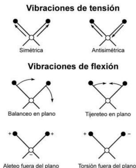
ILUSTRACIÓN 7. TIPOS DE VIBRACIONES GENERADAS POR LA ABSORCIÓN DEL HAZ IR.
