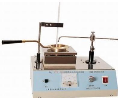
ILUSTRACIÓN 53. MEDIDOR DE PUNTO DE FLAMA
