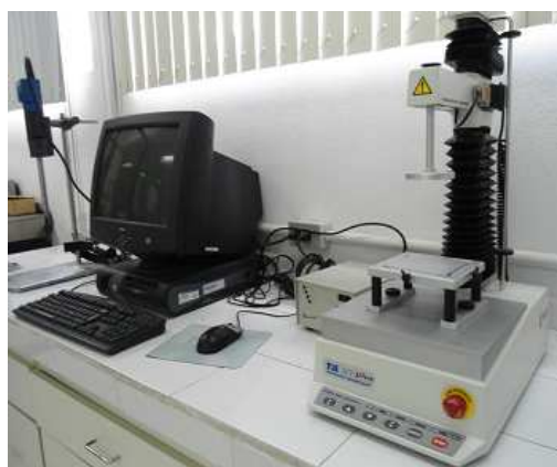
Figura 22. Equipo utilizado para obtener las curvas deformación vs tensión
