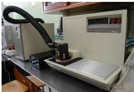
Figura 23. Calorímetro diferencial de barrido utilizado para la determinación T_m , T_g y sus entalpías
