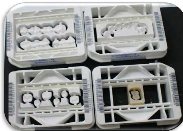
Fig.39 Marcos de Zirconia, del sistema Lava™ 3M Espe presinterizados y no sinterizados.
