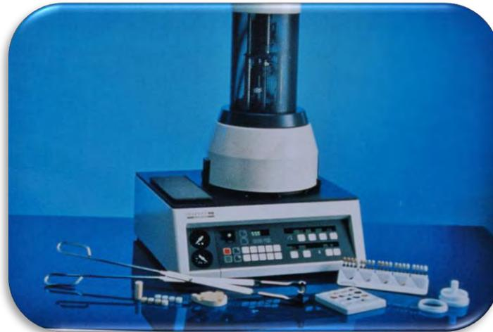
*Fig.3 Scanner del sistema Empress I.*
