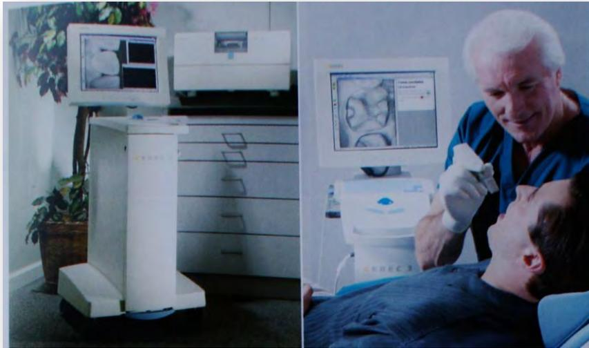
*Fig.15 Sistema CAD-CAM ordenador y sistema de fresado con sistema de impresión óptica.*
