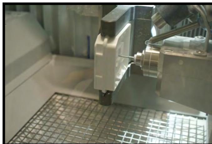
*Fig.90 Fresa desgastando el marco de zirconia.*
