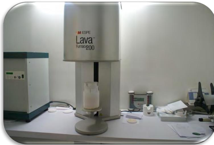
*Fig.94 Proceso de sinterización del núcleo en el Lava™ Frame 200.*
