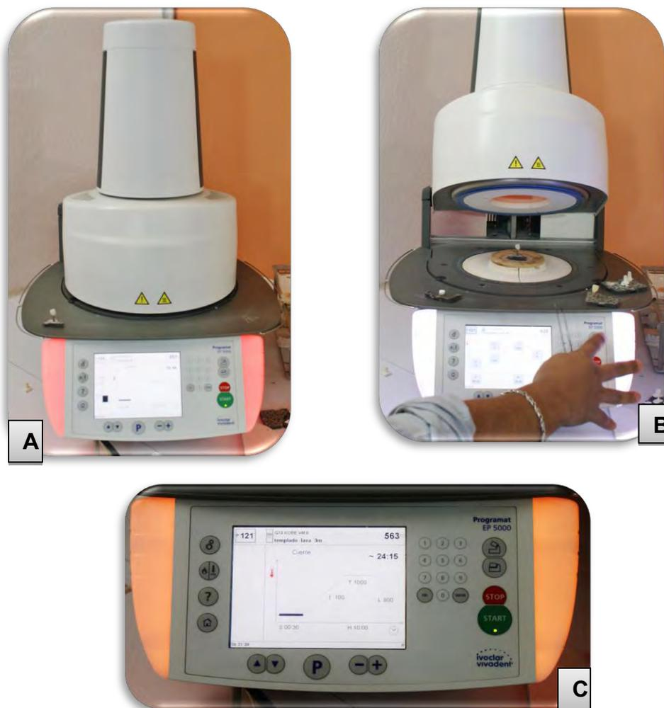
*Fig. 99 A) Horno al vacío. B) Núcleo de zirconia en proceso de templado. C) Pantalla que marca los 1000 °C del proceso.*
