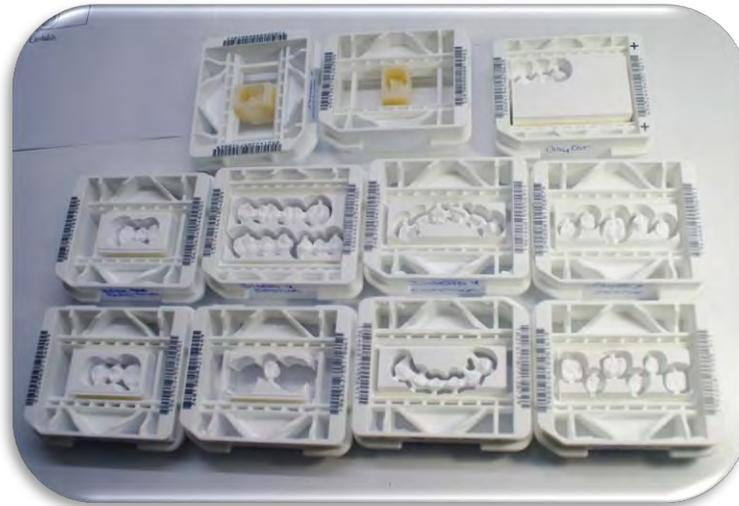
*Fig.40 Bloques fresados Lava™ Frame.*
