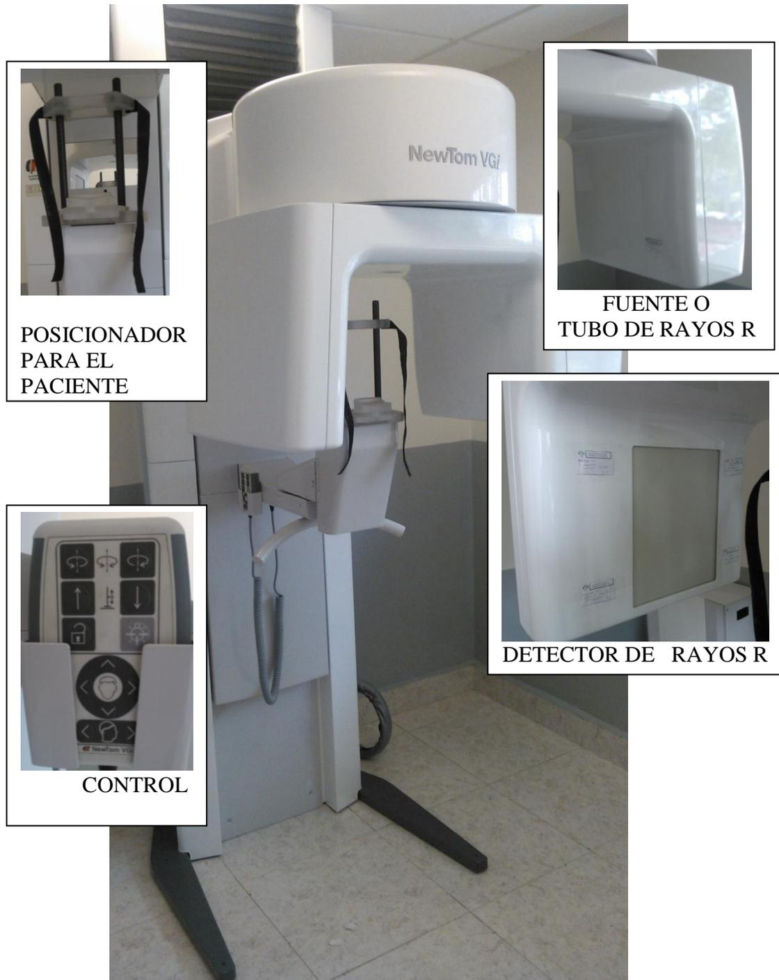
FIGURA 8. Componentes del tomógrafo.
