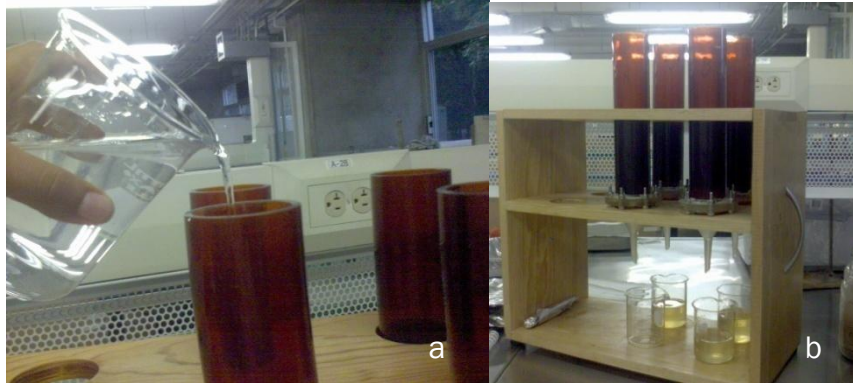
Figura 5.5 Operación de las columnas de suelo, a) alimentación manual b) recolección de lixiviados.
