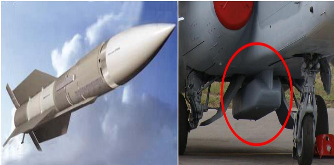
Figura 2.4. Radomos en misiles y debajo del fuselaje de un avión.
