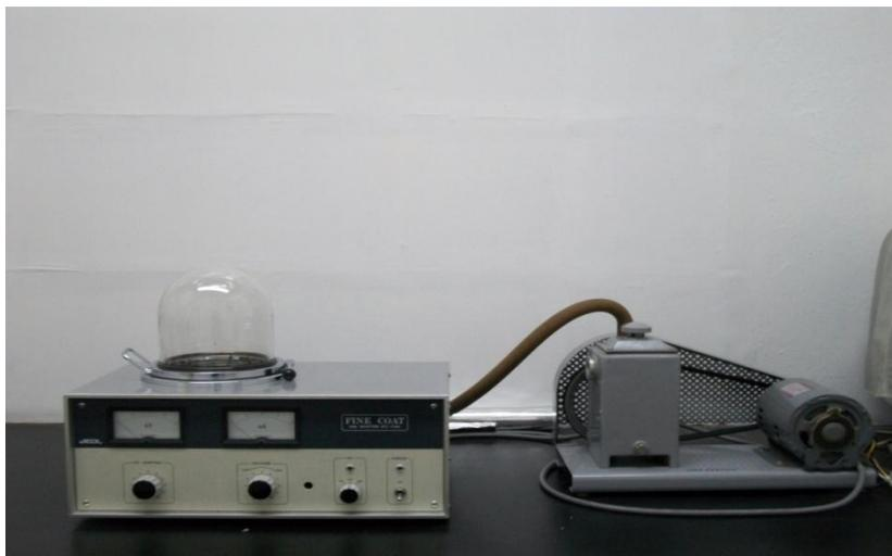
Figura 3.4. Equipo de Ionización, para recubrir muestras con una capa de oro, junto con la bomba de vacío.
