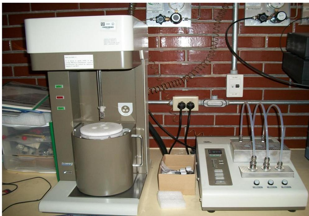
Figura 3.6. Equipo Minisorp II para medición de área superficial (izquierdo), junto a este se muestra el equipo para desgasificar las muestras, Bel Prep II.
