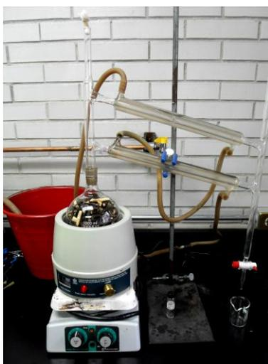
Después se depositaron en un matraz de fondo redondo de 500mL. El matraz se colocó en una mantilla de calentamiento eléctrica. Se montó el sistema de refrigeración. Se esperó a que hirviera ligeramente y se recolectó el aceite esencial.
