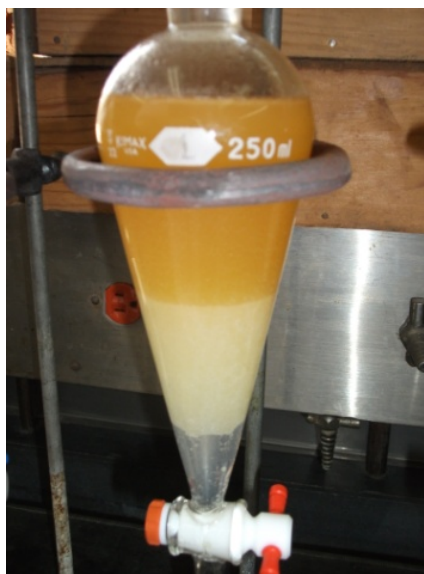
Figura 18. Lavado del biodiesel.
