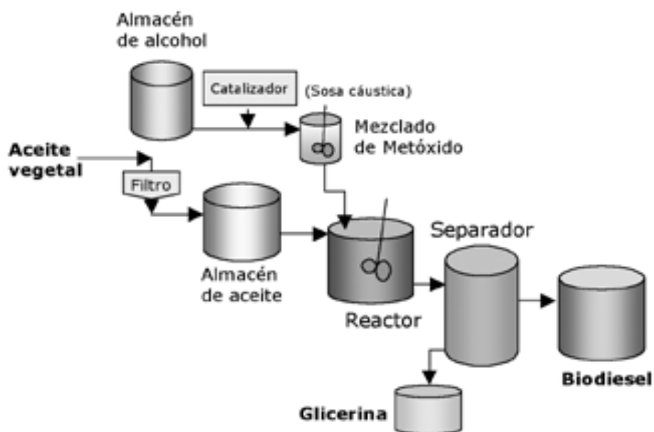
Figura 16. Proceso de producción del biodiesel.
