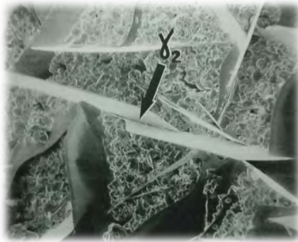
Figura 2. Microscopía electrónica de barrido de cristales de Sn- Hg ( \gamma_2 ) que se producen en una matriz de amalgama convencional. Roberson, Theodore; 2007
