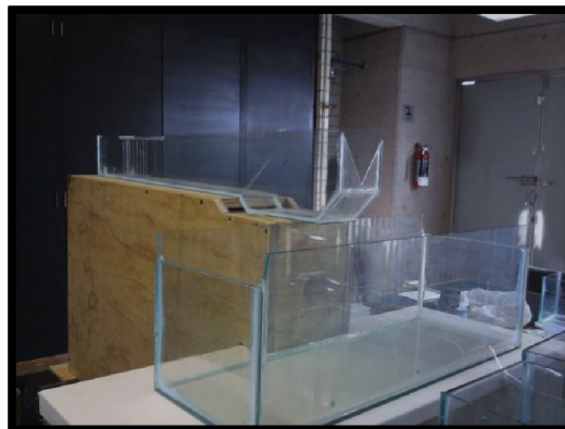
Figura 3.1. Caja distribuidora del afluente a los humedales.
