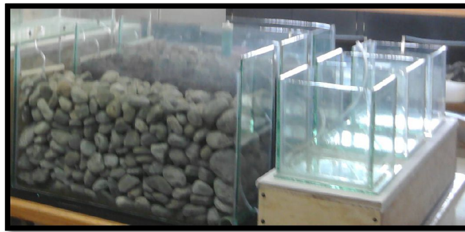
Figura 3.4. Profundidad del sustrato en el humedal con soporte de piedra de río.
