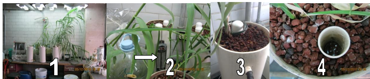
Figura C.1. Área de trabajo: 1) Mesa de trabajo soportando los biorreactores y en la parte superior el sistema de iluminación artificial; 2) Colocación de un termómetro de máxima y mínima para el registro diario de temperaturas; 3) Puerto de muestreo para electrodos en la parte superior y puerto de muestreo de efluente a 5cm, por un costado; 4) Puerto de muestreo para electrodos mostrando el nivel de agua, también puede verse el lecho de escoria volcánica (tezontle) con una granulometría de 0.5cm y porosidad de 0.54.
