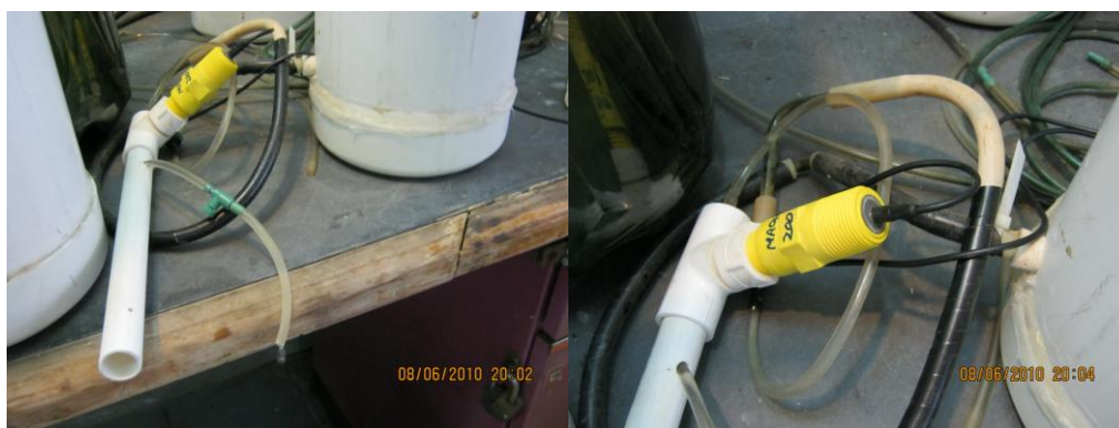
Figura C.6. Medición del potencial redox en el puerto de 35cm de profundidad de la columna.
