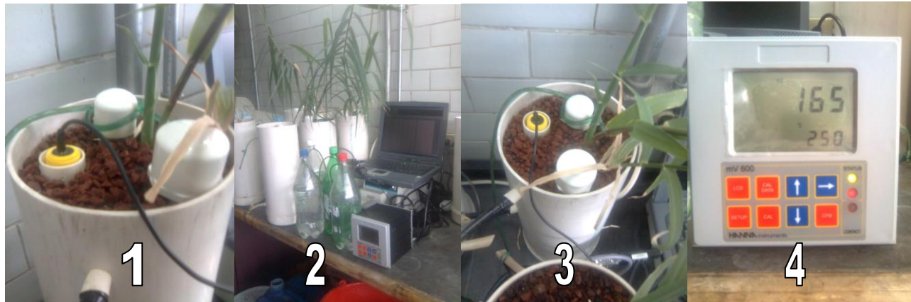
Figura C.3. Las imágenes muestran la instalación del equipo mV600, controlador del potencial de óxido-reducción para la medición y registro de las lecturas. 1) Electrodo de potencial de óxido reducción en el puerto de muestreo para electrodos; 2) Biorreactores, PC y controlador mV600; 3) Ubicación del electrodo de potencial de óxido reducción en el puerto de muestreo a 5cm de profundidad; 4) Carátula del controlador de potencial de óxido-reducción Hanna mV600.
