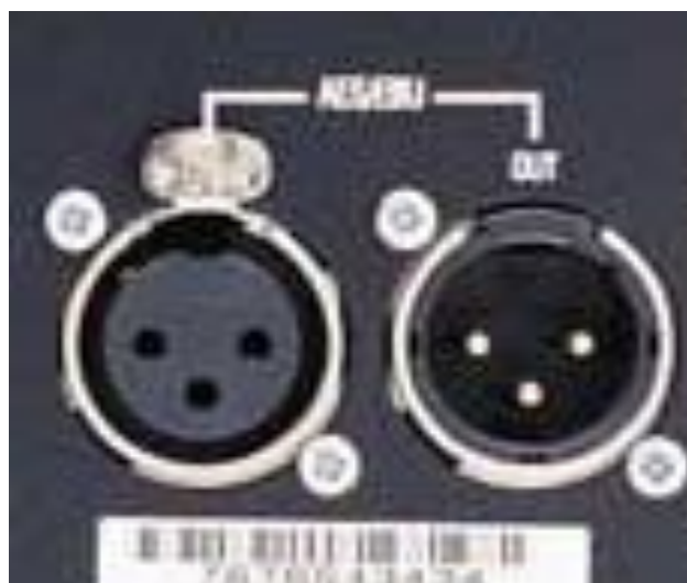
Figura 2.18. Conectores de entrada y salida digital estéreo
