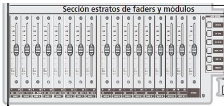
Figura 2.6 Sección estrados de faders y módulos
