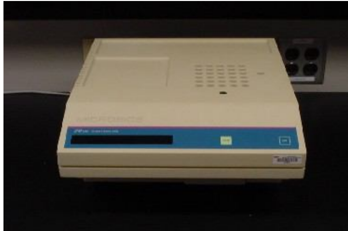
Figura 2. Sistema Microtox empleado para realizar bioensayos con Vibrio fischeri .
