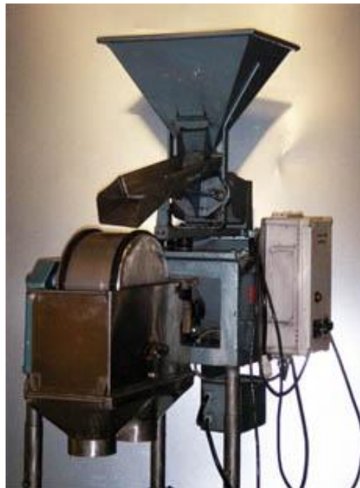
Figura 26: Separador magnético seco tipo tambor de baja intensidad
