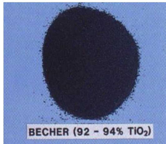
Figura 32: Rutilo sintético producido a través del proceso Becher
