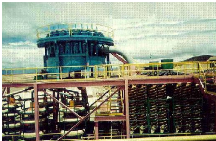
Figura 18: Banco de espirales, la imagen también muestra un banco de hidrociclones en la parte superior y en la parte inferior izquierda un banco de conos reichert, todos parte del sistema de separación gravimétrica húmeda
