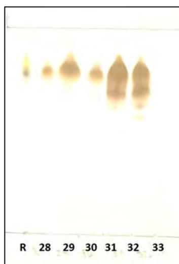
Figura 9. Cromatograma de fracciones con resinas glicosídicas ( $\text{CHCl}_3$ :MeOH 80:20).
