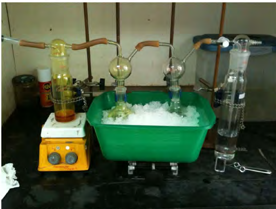
Figura 4.2. Sistema para la producción de dióxido de cloro a nivel laboratorio
