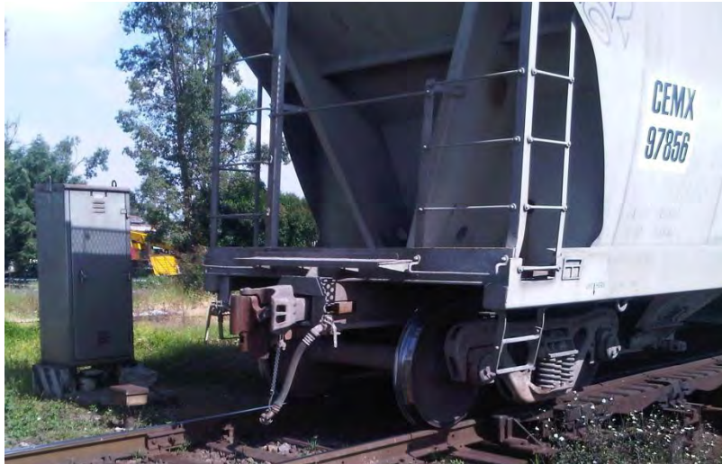
ILUSTRACIÓN 3: FOTOGRAFÍA DE UNA TOLVA CEMENTERA
