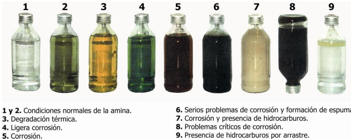
**Figura 2.5** Condiciones de la alcanolamina en función de las condiciones a las cuales opera el proceso (Sheilan H., 2007).
