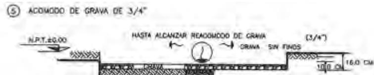
6. Una vez acomodada la base de grava de  $\frac{3}{4}$ " y perfectamente nivelada y afinada se procederá a realizar los trabajos de colocación del Concreto Ecologico hecho con Ecocreto con espesor de 6cm. Con un  $f'c = 200 \text{ kg/cm}^2$ .
