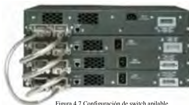
Figura 4.7 Configuración de switch apilable
