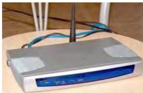
Figura 1.13 Punto de acceso inalámbrico
