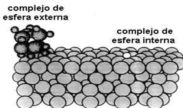
**Figura 36. Interacción de iones en la superficie arcillosa.**
