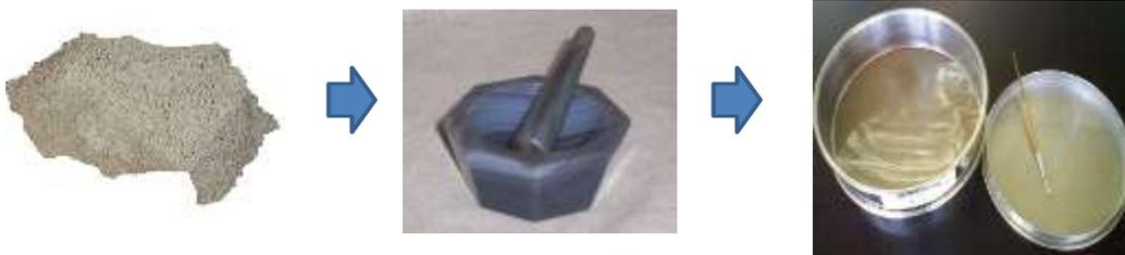
Homoionización de los minerales con NaCl y CaCl<sub>2</sub> 1N, 48 h.
