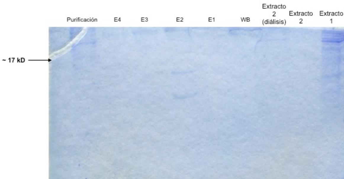
Figura 8: Tinción de Coomassie de las muestras obtenidas a partir de la Extracción (Extracto 1 y Extracto 2 y Extracto 2 con Diálisis) y la Purificación (Buffer de Lavado (WB), Elución 1, 2, 3 y 4 respectivamente (E1, E2, E3, E4) y lo pasado por la columna de purificación
