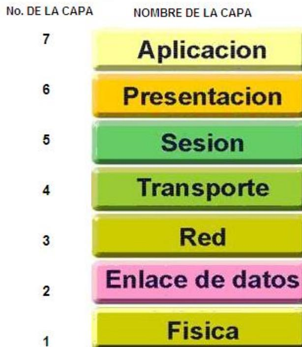
FIGURA 1. MODELO DE REFERENCIA OSI DE ISO
