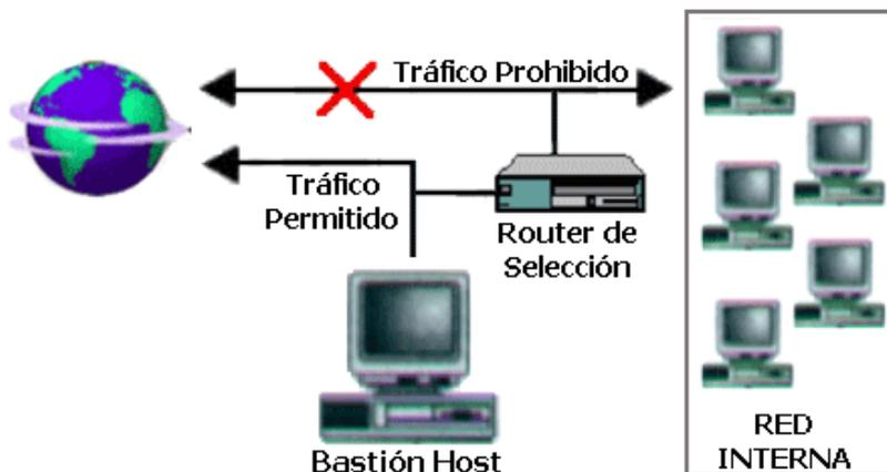
DIAGRAMA 7. CONECTIVIDAD DE UN CORTAFUEGO EN ESQUEMA SCREENED HOST.
