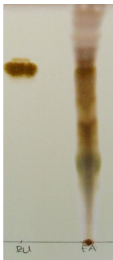
Figura 11. Perfil cromatográfico por CCF del extracto acuoso de C. filaginoides . Carril 1, rutina; carril 2, extracto acuoso. Fase móvil: AcOEt:MeOH:H 2 O (7:2:1). Fase estacionaria: sílica gel (Merck, tamaño de partícula: 5-20 \mu m). Solución reveladora de sulfato cérico amoniacal.
