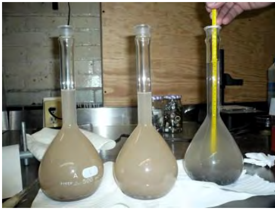
Figura 2. Vista del material usado para la prueba de densidad de sólidos en el laboratorio de mecánica de suelos. De lado derecho se observa la toma de lecturas de temperatura. De lado izquierdo las muestras a baño maría.
