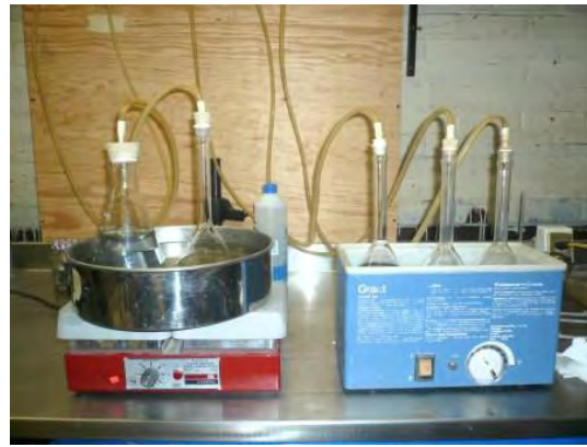
Figura 2. Vista del material usado para la prueba de densidad de sólidos en el laboratorio de mecánica de suelos. De lado derecho se observa la toma de lecturas de temperatura. De lado izquierdo las muestras a baño maría.
