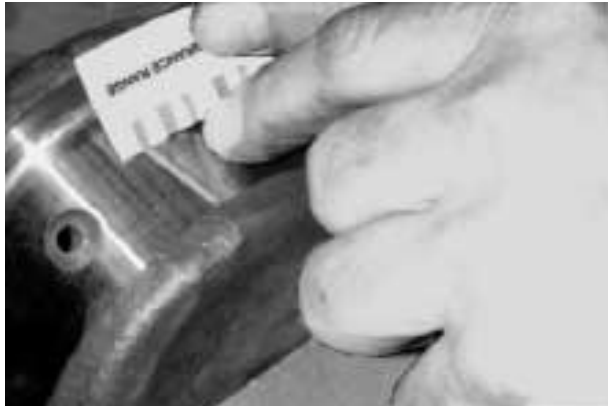
Uso de plastigage en el cigüeñal para determinar la medida del cojinetes de biela
