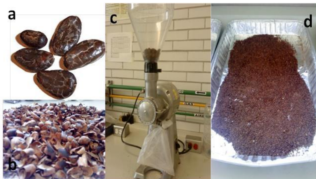
Figura 3.6. Representación de: a) grano de cacao descascarillado, b) cascarilla, c) molino de discos y d) licor de cacao
