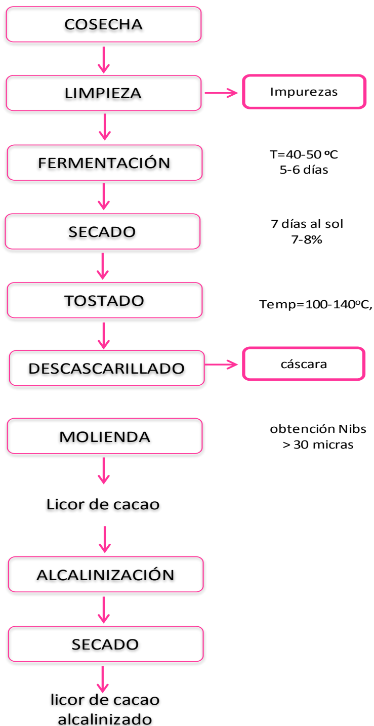
Figura 1.4. Diagrama de bloques del proceso de elaboración de licor de cacao
