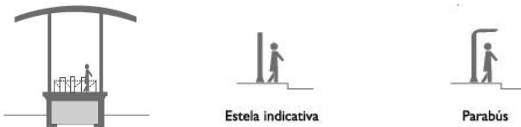
Figura V.1 Estación cerrada Figura V.2 Parada tipo estela Figura V.3 Parada tipo parabus
