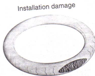
Fig. 48 daños del aditamento producidos por una mayor compresión y estiramiento del aditamento, debe de lubricarse diariamente para evitar estos problemas.
