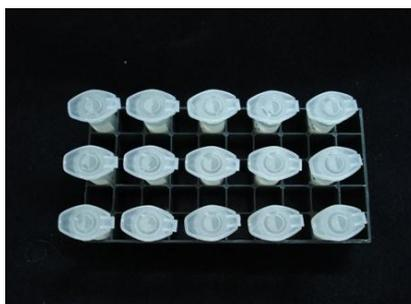
Figura 11. Muestras enfrascadas con agua ionizada a  $37\pm 1^{\circ}\text{C}$ .
