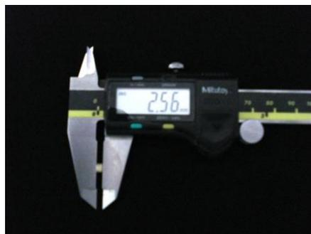
Figura 7. Medición de resina polimerizada.
