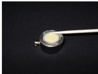
Figura 17. Colocación de la resina.
