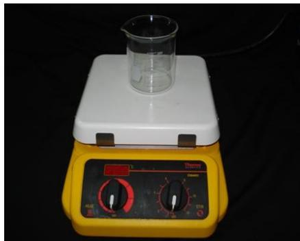
Figura 1. Mezcla de los materiales con agitador magnético.
