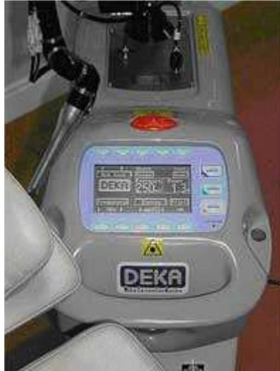
Imagen 1: Pantalla de computadora del equipo de láser Er:YAG, en donde se gradúa la frecuencia, la energía y la potencia en Wattios, con la cual se va a trabajar.
