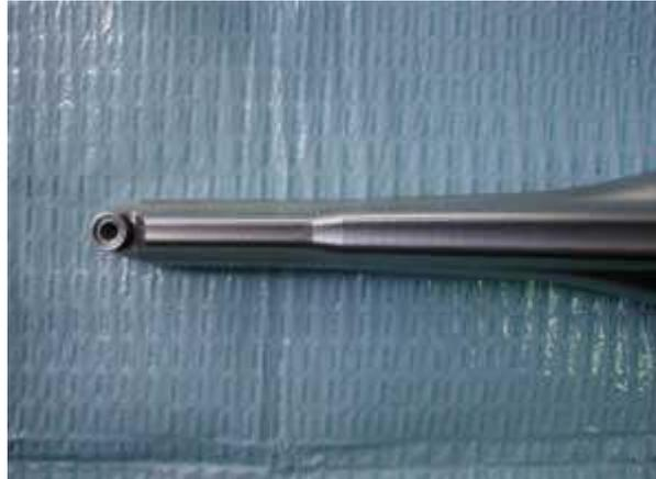
Imagen 2: Manipulo a distancia del láser Er:YAG, donde se aprecia la ventana de zafiro por donde emerge el rayo y las salidas de agua y aire del sistema de enfriamiento focal. (Fuente: *El láser Er: YAG como alternativa en la práctica odontológica operatoria*)
