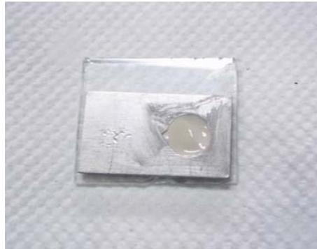
Foto 8. Cemento sellador AH plus® en el molde metálico.
