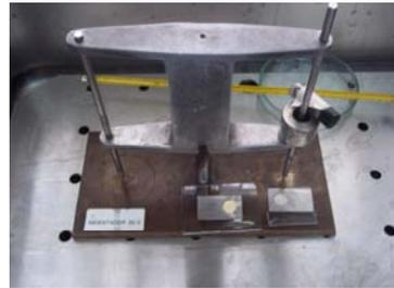
Foto 15. Aguja Gilmore en la cabina de temperatura controlada (Horno Poly Science)
