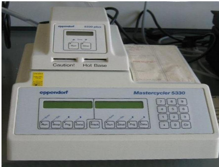
Fig. 2: Termociclador: en él se efectúa la PCR convencional.<sup>22</sup>
