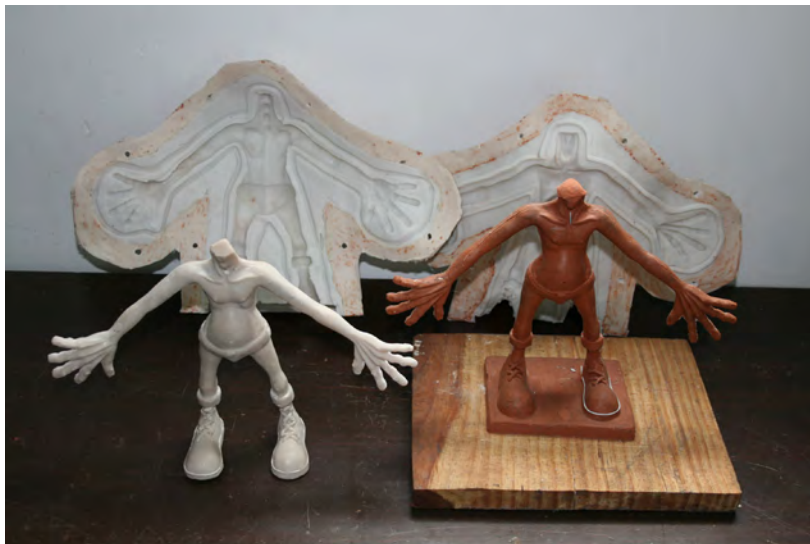
fig. 138 En la foto se puede apreciar el vaciado en resina y junto a ella el modelado original en plastilina. En la parte posterior se encuentra el molde abierto con el que fue hecho el vaciado.
