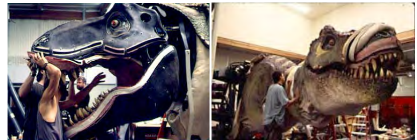
fig. 146 Etapas en la creación del animatrónico de un Tiranosaurio Rex. Como se puede ver pueden tener un gran tamaño, y el silicón con el que hacen su piel debe tener gran flexibilidad y resistencia para soportar la apertura de mandíbulas tan grandes.
