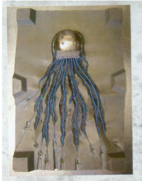
figs. 163 y 164 En la primera imagen se puede ver el molde abierto con la armadura en su interior del cabello del personaje The Corpse Bride de la película homónima. En la foto inferior se aprecia como queda terminado el cabello.
