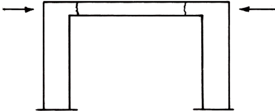
Fig. 4.9 Fisuras producidas por retracción en viga en pórticos de pilares de gran rigidez
