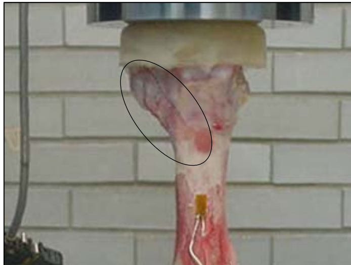
Figura 3.6. Trayectoria de una fisura oblicua localizada entre la epífisis y la zona metafisaria proximal de un hueso femoral de porcino sometido a ensayo de compresión.
