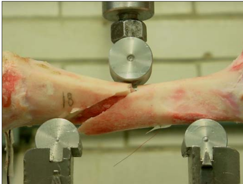
Figura 3.8. Fractura antero-posterior oblicua que se inició aparentemente en las zonas de contacto.
