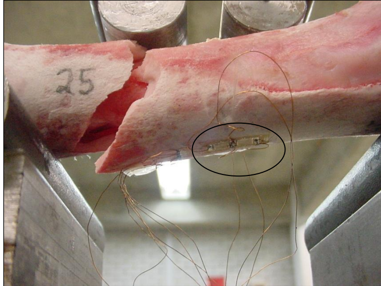
Figura 4.1. Hueso femoral de porcino instrumentado con una roseta (extensómetro de dos rejillas activas) y ensayado a flexión en cuatro puntos.
