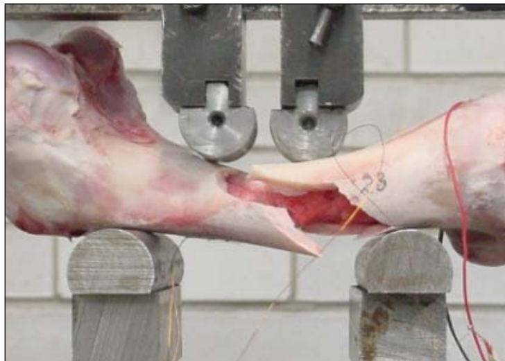
Figura 3.15. Fractura en espiral por efectos de esfuerzos de flexión y torsión.
