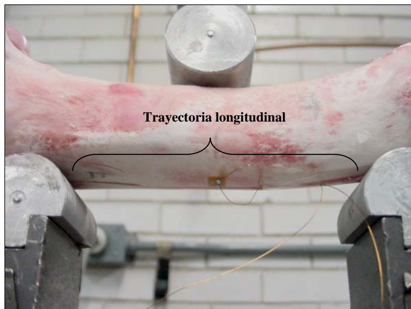
Figura 3.11. Fractura longitudinal localizada en la zona anterior del hueso largo.
