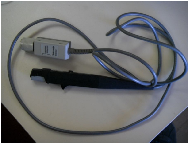
Imagen 8.7. Punta de corriente “TEKTRONIX”, modelo: TCP202
