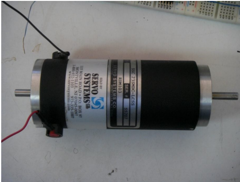
Imagen 8.1. Motor "PMDC" SERVO SYSTEMS CO., Modelo: SSC 23SMDC-LC55
